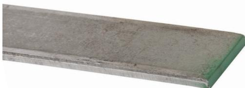
3/4 po x 1/8 po x 3 pi plat en acier doux plaqué. Alliage d'acier ordinaire doux A36 de calibre 12. Acier de construction courant aux États-Unis. Limite d'élasticité minimale de 36 000 PSI (250 MPa) et résistance ultime à la traction de 58 000 à 80 000 PSI (400 - 500 MPa).
