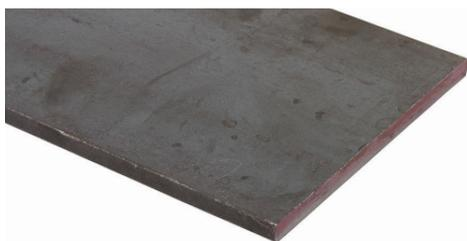
Plaque en acier doux laminé à chaud. Alliage d'acier ordinaire doux A36. 12 po de longueur x 4 po de largeur x 1/4 po d'épaisseur. Acier de construction courant aux États-Unis. Limite d'élasticité minimale de 36 000 PSI (250 MPa) et résistance ultime à la traction de 58 000 à 80 000 PSI (400 - 500 MPa). L'acier doux laminé à chaud est polyvalent et économique.
