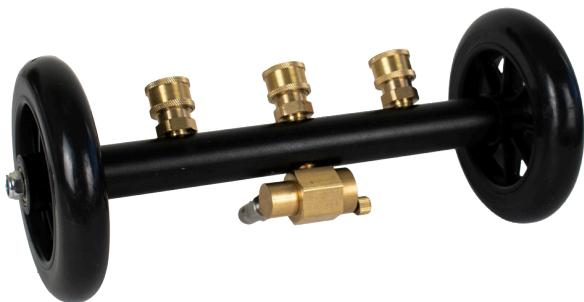
Ce balai à eau de 12 po (304,8 mm) est équipé d'une prise à raccord rapide de 1/4 po (6,35 mm) et de 4 sorties de buse de 65°. Attachez-le simplement à la tige ou à la lance d'une laveuse haute pression à l'aide de la sortie du coupleur à raccord rapide de 6,35 mm (1/4 po) pour nettoyer efficacement les terrasses, les sols de garage, les trottoirs, les allées et autres grands espaces.
