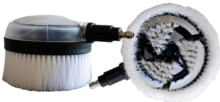
Cette brosse de nettoyage rotative en polypropylène est dotée d'une prise à raccord rapide de 1/4 po (6,35 mm) et est conçue pour nettoyer en profondeur et éliminer la saleté tenace sans endommager les surfaces. Attachez simplement la brosse à une tige de laveuse haute pression avec coupleur à raccord rapide femelle de 1/4 po (6,35 mm). Elle est idéale pour le lavage de voitures et autres tâches de nettoyage douces mais efficaces.
