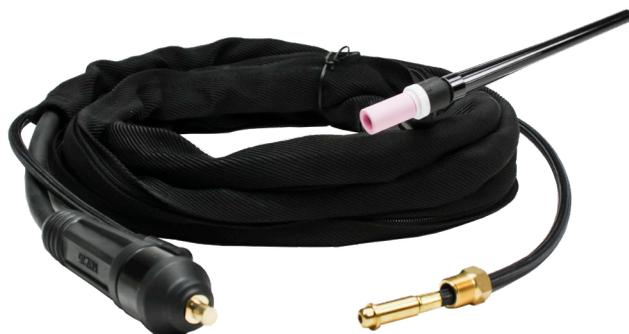
Chalumeau TIG à tête flexible monopièce refroidi à l'air avec valve sur le manche. Gamme d'électrodes : 0,020 à 3/32 po (0,5 à 2,4 mm). Connexion Dinse 25 Compatible avec les machines de 200 A ou moins avec connexion Dinse de dimension 25.
