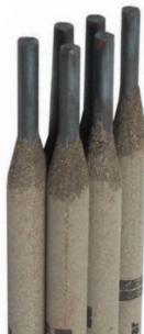
Les électrodes spécialisées de rechargement dur à haute résistance à l'abrasion et à l'usure sont idéales pour les pièces qui exigent un haut niveau de durabilité en raison des chocs violents et de l'abrasion moyenne auxquels elles sont soumises. Traitement thermique possible. Dureté : RC 58-60. Polarité recommandée : Polarité inverse en c.c. ou c.a.
