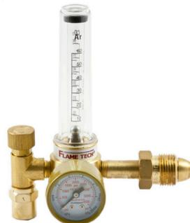
Détendeur et débitmètre en un seul appareil. Permet une régulation précise du débit de gaz. Corps en laiton usiné résistant aux chocs, tube de débit et enveloppe extérieure en polycarbonate. Conçu pour les applications MIG, TIG et MAG.
