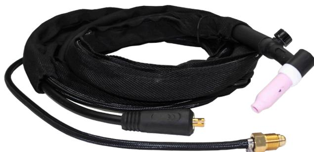
Chalumeau TIG à tête flexible monopièce refroidi à l'air avec valve sur le manche. Gamme d'électrodes : 0,020 à 3/32 po (0,5 à 2,4 mm) Compatible avec les machines de 200 A ou moins avec connexion Dinse de dimension 25.
