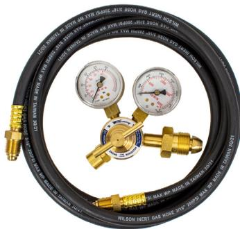
Détendeur Argon/CO2 avec tuyau 3 mm x 10 pi (3 m) pour soudage MIG ou TIG. Utilise un raccord d'entrée CGA-580 standard et une sortie fileté 5/8-18 RH. La capacité nominale est de 60 SCFH et la pression d'entrée de 4000 PSI.
